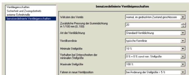
**HINWEIS:** Diese Parameterseite ist nur sichtbar, wenn auf der Parameterseite „Ventileigenschaften“ bei „Ventileinstellungen“ die Option „benutzerdefiniert“ ausgewählt wurde.
