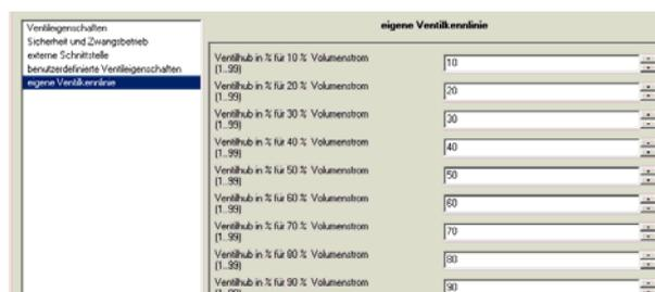
**HINWEIS:** Diese Parameterseite ist nur sichtbar, wenn auf der Parameterseite „Ventileigenschaften“ bei „Ventileinstellungen“ die Option „benutzerdefiniert“ und auf der Parameterseite „benutzerdefinierte Ventileigenschaften“ unter „Ventilkennlinie“ „eigene Kennlinie“ ausgewählt wurde.
