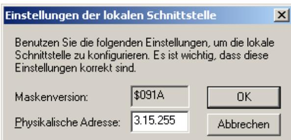
Der angezeigte Wert für die zusätzliche physikalische Adresse bei einer neuen IP Schnittstelle ist 15.15.255. Geben Sie die gewünschte zusätzliche physikalische Adresse ein und bestätigen Sie diese Eingabe mit OK. Die ETS3 setzt diesen Wert und schließt das Fenster.
