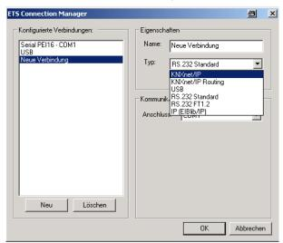
Erzeugen Sie eine neue Schnittstelle und wählen Sie als Typ KNXnet/IP.
