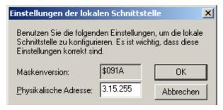
Der angezeigte Wert für die zusätzliche physikalische Adresse bei einer neuen IP Schnittstelle ist 15.15.255. Geben Sie die gewünschte zusätzliche physikalische Adresse ein und bestätigen Sie diese Eingabe mit OK. Die ETS3 setzt diesen Wert und schließt das Fenster.
