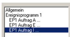
Entsprechend der Anzahl der zu verwendeten Ereignisaufträge, wird die Parametrierung dieser Aufträge in maximal 3 Fenstern angezeigt, EP1: Auftrag A..., EP1: Auftrag E..., EP1: Auftrag I...
