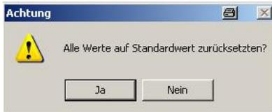
Wird der Button „Ja“ betätigt, so werden alle Parameter auf ihre werkseitige Standard-Einstellung zurückgesetzt. Alle nicht über die Export-Funktion archivierten Einstellungen gehen hierdurch verloren.
