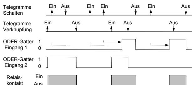
**8. Schalten mit UND - Verknüpfung, mit Einschalt- und Ausschaltverzögerung**
