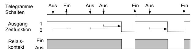
**4. Schalten mit Einschaltverzögerung und Ausschaltverzögerung, ohne Verknüpfung**
