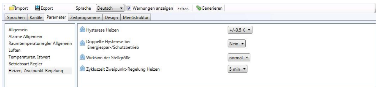
Abb. 68. Parameteransicht: Heizen, Zweipunkt-Regelung
