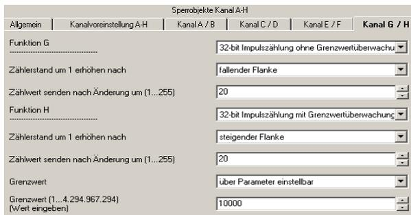
Diese Funktion ermöglicht bei Binäreingängen das Zählen und Speichern von Impulsen als 32-bit Zählwert. Der im Zählwertobjekt gespeicherte Zählwert kann auf eine Anforderung hin und nach Änderung um einen parametrierbaren Differenzwert gesendet werden. Über ein zusätzliches 1-bit-Kommunikationsobjekt kann der Zählwert bei Bedarf per Telegramm auf den
