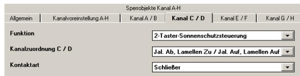
Mit einem Tasterpaar kann über eine lange Betätigung der Sonnenschutz bis zur jeweiligen Endlage herab- oder hochgefahren werden sowie über einen kurzen Tasterdruck die Fahrt beendet bzw. die Lamellen um einen Schritt verstellt werden. Es ist einstellbar, mit welchem Taster (bzw. Kanal) der Sonnenschutz herab gefahren und die Lamellen ggf. um einen Schritt geschlossen werden sollen bzw. der Sonnenschutz hochgefahren und die Lamellen ggf. um einen Schritt geöffnet werden sollen.
