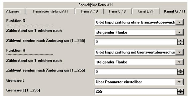
Diese Funktion ermöglicht bei Binäreingängen das Zählen und Speichern von Impulsen als 8-bit Zählwert. Der im Zählwertobjekt gespeicherte Zählwert kann auf eine Anforderung hin und nach Änderung um einen parametrierbaren Differenzwert gesendet werden. Über ein zusätzliches 1-bit-Kommunikationsobjekt kann der Zählwert bei Bedarf per Telegramm auf den Wert 0 zurückgesetzt werden. Über Parameter ist einstellbar, ob das Erhöhen des Zählerstandes bei steigender oder fallender
