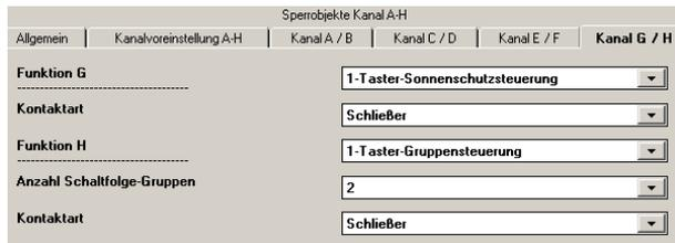
Der Kanal kann für 1-Taster Sonnenschutzsteuerung genutzt werden. Es wird zwischen kurzem und langem Tastendruck unterschieden.
