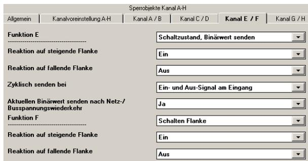
Diese Funktion z.B. dient zur Abfrage und Übertragung des Schaltzustands eines Kontaktes bzw. des an einem Kanaleingang liegenden Spannungspegels. Über Parameter ist einstellbar, welcher Binärwert nach einer Statusänderung zu senden ist, ob der Schaltzustand/Binärwert zusätzlich zyklisch zu senden ist und ob der aktuelle Schaltzustand/Binärwert auch nach Bus- bzw. Netzspannungs-Wiederkehr automatisch gesendet werden soll.
