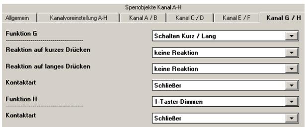
Diese Funktion dient bei Binäreingängen, an die ein Schalter oder ein Taster angeschlossen ist, zum Senden eines Schalttelegramms (EIN, AUS oder UM) als Reaktion auf ein kurzes oder langes Drücken des Tasters.
