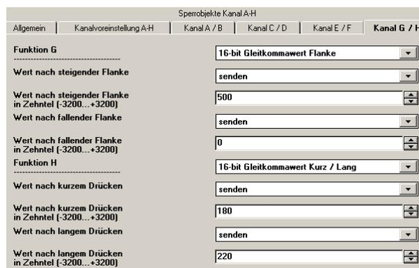
Diese Funktion dient zum Senden von 16-bit Gleitkommawerten (GK-Wert als EIS 5) im Bereich von -320,0...+320,0, mit einer Nachkommastelle. Der Exponent des 16-bit Gleitkommawertes ist hierbei auf den Wert „4“ fest eingestellt. Es ist einstellbar, ob ein Werttelegramm entweder als Reaktion auf eine steigende und / oder eine fallende Signalflanke an dem Kanaleingang (d.h. beim Drücken und / oder Loslassen eines Tasters z.B.) gesendet werden soll.
