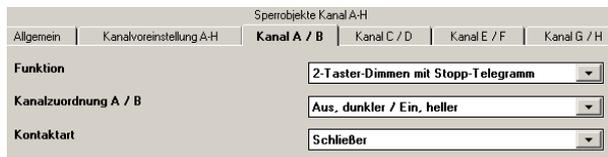
Mit dem an die beiden Kanäleingänge angeschlossenen Tasterpaar kann über ein kurzes Drücken ein- bzw. ausgeschaltet werden sowie über einen langen Tastendruck heller bzw. dunkler gedimmt werden. Es ist einstellbar, mit welchem Taster (bzw. Kanal) ausgeschaltet und dunkler gedimmt bzw. eingeschaltet und heller gedimmt werden soll.
