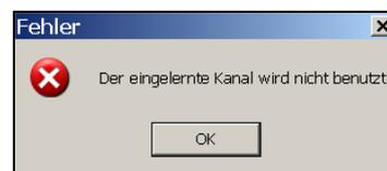
Nicht genutzte Kanäle eines wave-Gerätes können über Parameter gesperrt werden. Wird versucht, einen gesperrten Kanal einzulernen, erscheint diese Meldung.
