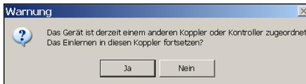
Bidirektionale Geräte können nur in einen Koppler oder Controller eingelernt werden, da dieser die Geräte über seine Domain Adresse (Seriennummer des Kopplers) anspricht. Diese Domain Adresse wird beim Einlernen in das bidirektionale Gerät geladen.
