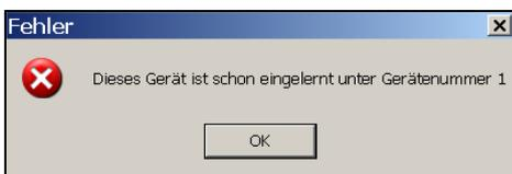
Wird versucht, ein bereits unter einer anderen Geräte-nummer eingelerntes Gerät erneut einzulernen, erscheint diese Meldung (z. B. Taste wave mit Universaldimmer Einsatz sys ist projektiert und eingelernt mit der Gerätenummer 1). Wird nun eine weitere Taste wave mit Universaldimmer Einsatz sys angelegt und versucht das bereits eingelernte Gerät erneut unter der neuen Gerätenummer einzulernen, erscheint diese Fehlermeldung.
