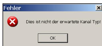
Bei einstellbaren Sensorkanälen ist darauf zu achten, dass die parametrisierte Sensorfunktion (Schalten, Schalten/Dimmen, Jalousie, Szene) mit der beim Einlernen am wave-Gerät eingestellten Funktion übereinstimmt. Ist dies nicht der Fall, erscheint diese Fehlermeldung.
