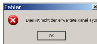
Bei einstellbaren Sensorkanälen ist darauf zu achten, dass die parametrisierte Sensorfunktion (Schalten, Schalten/Dimmen, Jalousie, Szene) mit der beim Einlernen am wave-Gerät eingestellten Funktion übereinstimmt. Ist dies nicht der Fall, erscheint diese Fehlermeldung.
