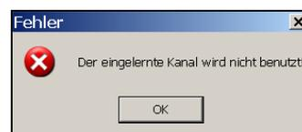
Nicht genutzte Kanäle eines wave-Gerätes können über Parameter gesperrt werden. Wird versucht, einen gesperrten Kanal einzulernen, erscheint diese Meldung.
