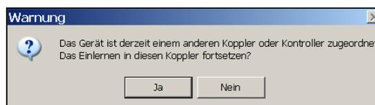
Bidirektionale Geräte können nur in einen Koppler oder Controller eingelernt werden, da dieser die Geräte über seine Domain Adresse (Seriennummer des Kopplers) anspricht. Diese Domain Adresse wird beim Einlernen in das bidirektionale Gerät geladen. Wurde dieses Gerät schon einmal in einen anderen Koppler eingelernt, erscheint diese Warnung, da nach dem erneuten Einlernen dieses Gerät nicht mehr von dem vorherigen Koppler angesprochen werden kann.
