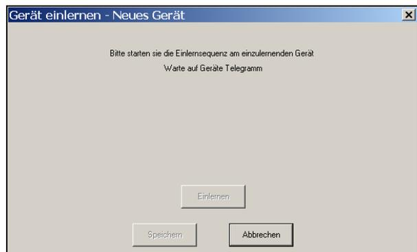
Der Koppler wartet auf die Einlernsequenz des wave-Gerätes.
