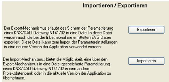
Der Exportmechanismus ermöglicht das Sichern der Parametrierung eines KNX/DALI Gateway N141/02 in eine Datei. In diese Datei werden auch die bei der Inbetriebnahme zugewiesenen Nummern und Namen der DALI EVGs exportiert. Diese exportierten Nummern, Namen und Gruppenzuordnungen gelten jedoch nur solange, wie bei dem zugehörigen KNX/DALI Gateway N141/02 kein erneutes Initialisieren von EVGs durchgeführt bzw. keine andere Applikation in das Gerät geladen wurde.
