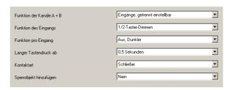
Diese Funktion ermöglicht es, 2-Tasten-Dimmen mit zwei beliebigen Eingängen auszuführen, wobei jeder Eingang nur die Funktion einer Taste ausführt:
