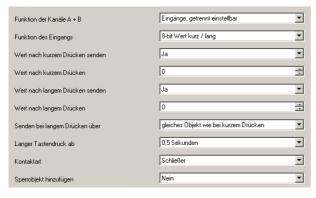
Diese Funktion dient zum Senden von 8-bit Ganzzahlwerten (EIS 6, DPT 5.010) im Bereich von 0...255. Es ist einstellbar, ob ein Werttelegramm entweder als Reaktion auf ein kurzes und / oder langes Drücken eines Tasters gesendet werden soll.
