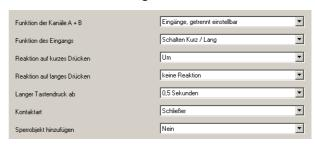
Diese Funktion dient bei Eingängen, an die ein Taster angeschlossen ist, zum Senden eines Schalttelegramms (EIN, AUS oder UM) als Reaktion auf ein kurzes oder langes Drücken des Tasters.
