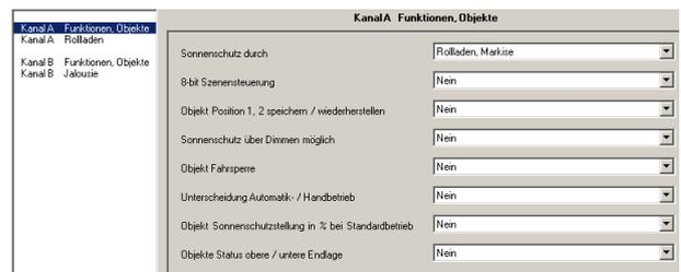
Dieses Parameterfenster dient zur Auswahl der Basisfunktion (Sonnenschutz durch Jalousie / Rollläden/Markise) und weiterer Funktionen dieses Aktormodulsausgangs. Dies umfasst,
