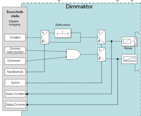
Schematischer Aufbau eines Dimmaktorkanals
