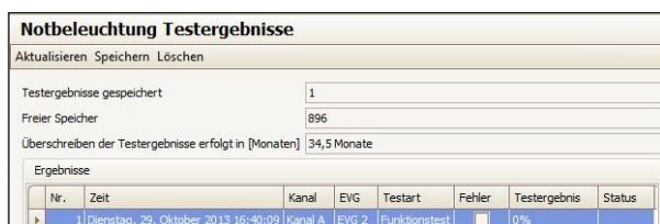
Abb. 14 Parameterfenster Notbeleuchtung Testergebnisse
