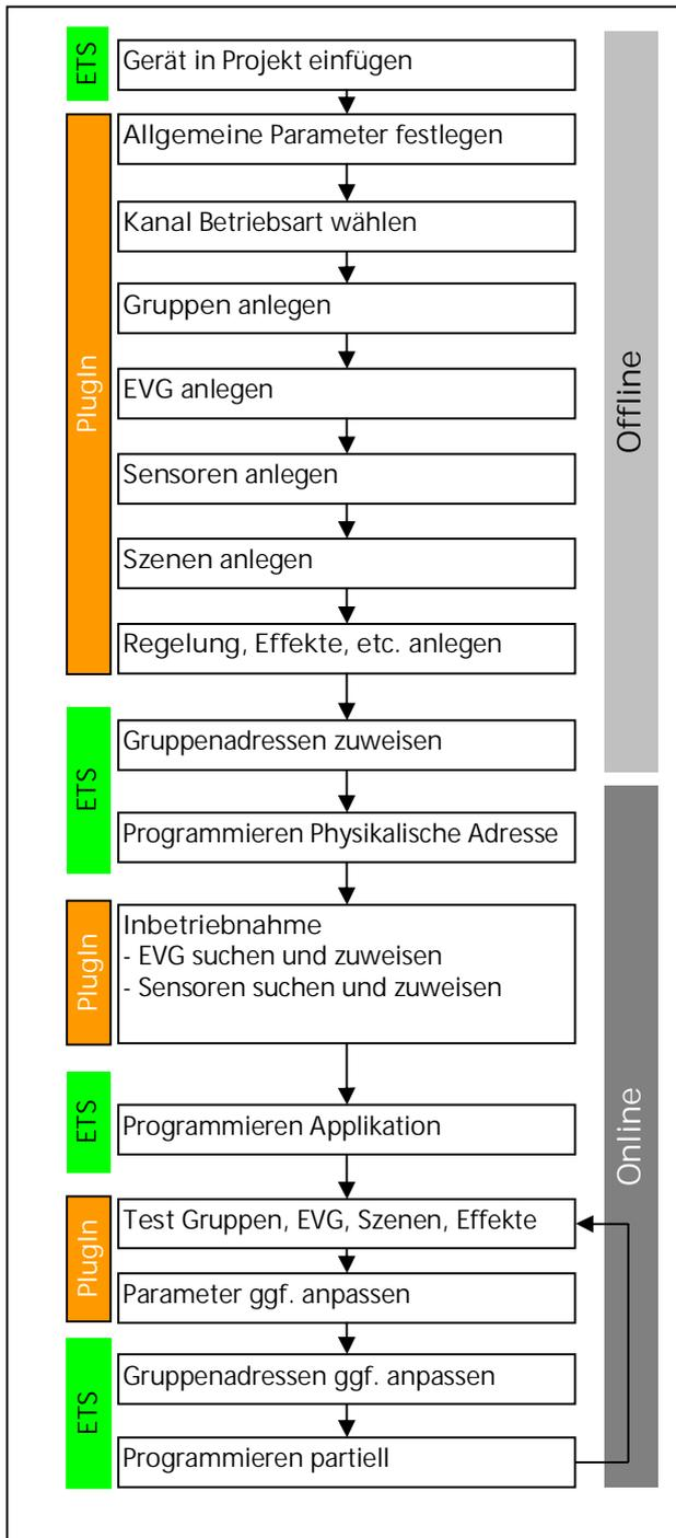
Abb. 1 Konfigurationsschritte
