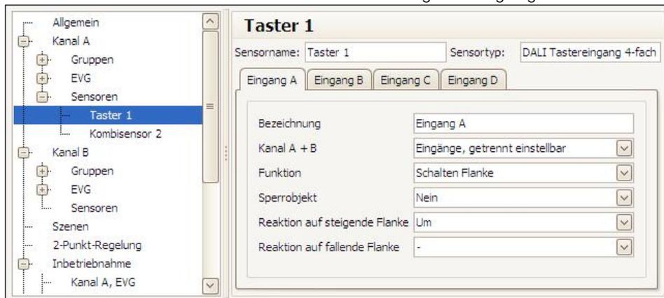
Abb. 17 Tasterschnittstelle - Details
