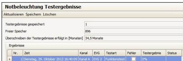
Abb. 14 Parameterfenster Notbeleuchtung Testergebnisse
