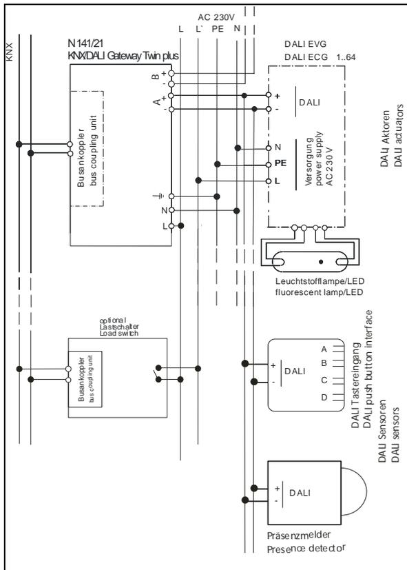
Abb. 21 Anschlussbeispiel für Stand-by Abschaltung mit Lastschalter
