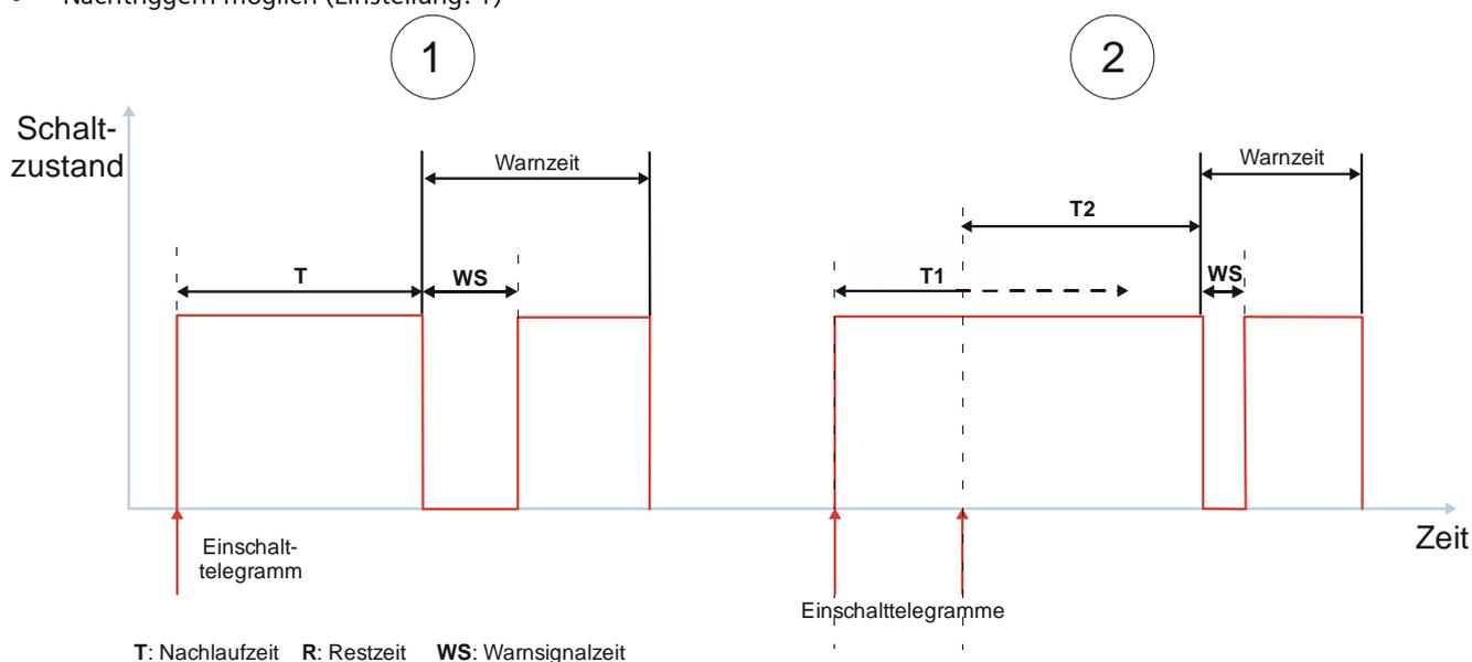
Abb. 33 Verhalten bei Zeitschalterbetrieb mit Einstellung „Warnen vor Ausschalten“ = „kurzes Aus-/Einschalten“ und „Nachtriggern möglich“ = „1“
