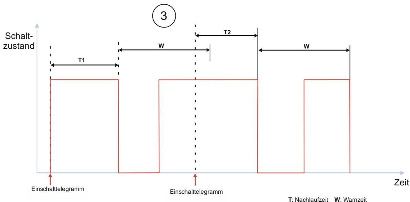
Abb. 34 Verhalten bei Zeitschalterbetrieb mit Einstellung „Warnen vor Ausschalten“ = „kurzes Aus-/Einschalten“ und „Nachtriggern möglich“ = „1“
