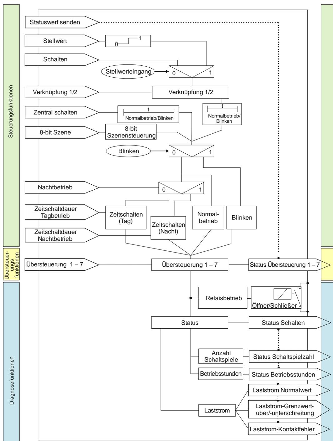
Abb. 1 Schematischer Aufbau eines Schaltaktorkanals (es werden nicht alle Kommunikationsobjekte dargestellt)
