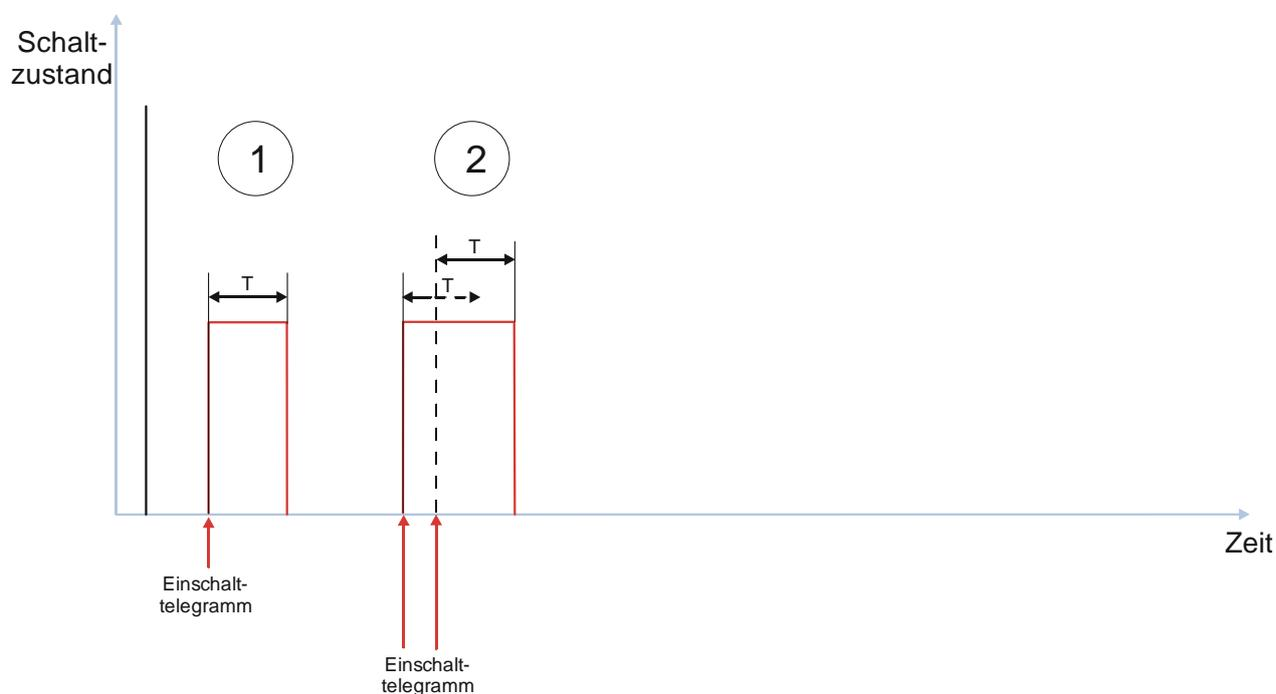
Abb. 30 Verhalten bei Zeitschalterbetrieb mit Einstellung „Nachtriggern = 1“
