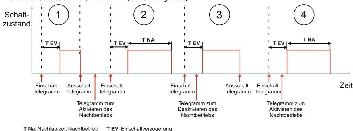
Abb. 37 Verhalten bei parametrierter Einschaltverzögerung im Normalbetrieb und Nachtbetrieb
