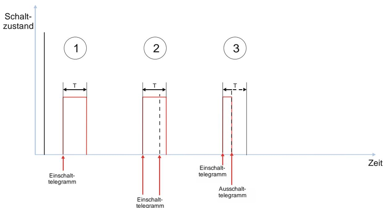
Abb. 29 Verhalten bei Zeitschalterbetrieb mit Einstellung „Nachtriggern = 0“
