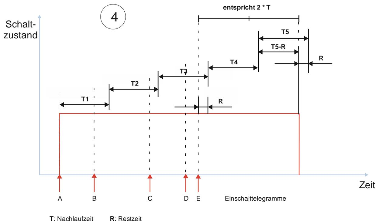
Abb. 32 Verhalten bei Zeitschalterbetrieb mit Einstellung „Nachtriggern möglich“ = „2“
