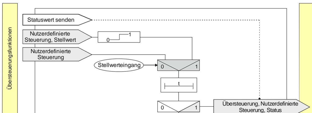
Abb. 16 Übersteuerung Nutzerdefinierte Steuerung
