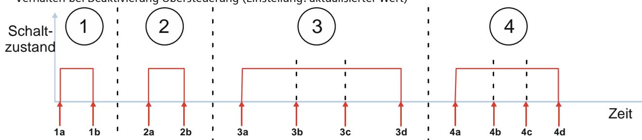
Abb. 38 Verhalten der Übersteuerungen des Kanals beim „Ein/-Ausschalten“ (Beispiel mit Übersteuerung „Hand EIN“)
