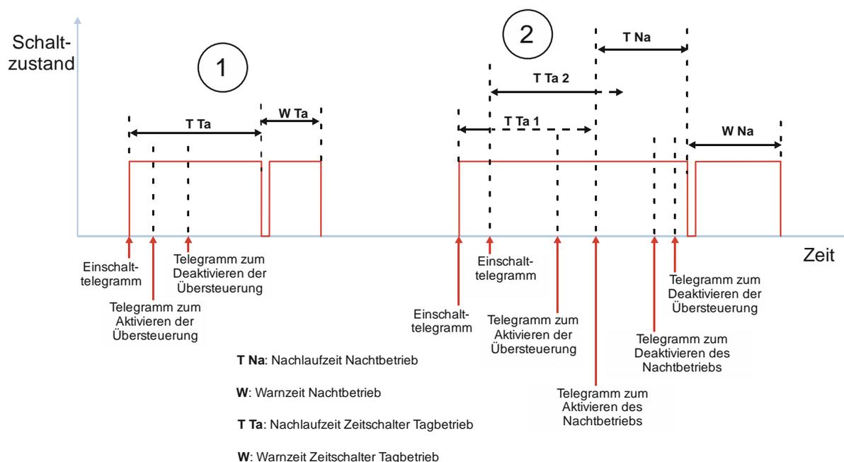
Abb. 40 Verhalten des Schaltaktors im Zeitschalterbetrieb mit Nachtbetrieb, parametrierter Übersteuerung (Zwangsführung) und Vorgabe zum Neustart des Zeitschalters bei Deaktivierung der Übersteuerung
