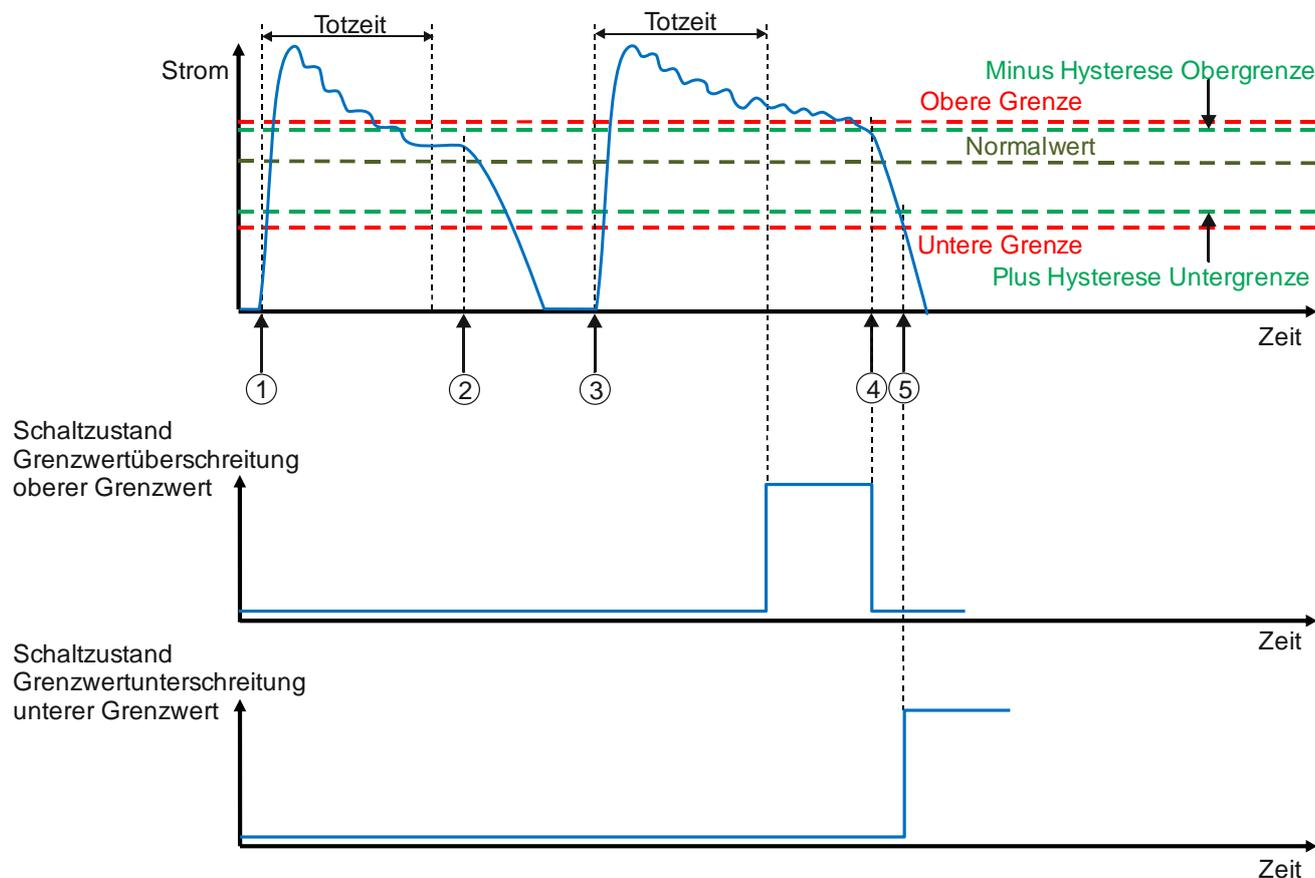
Abb. 22 Darstellung Grenzwertüberwachung mit Totzeit
