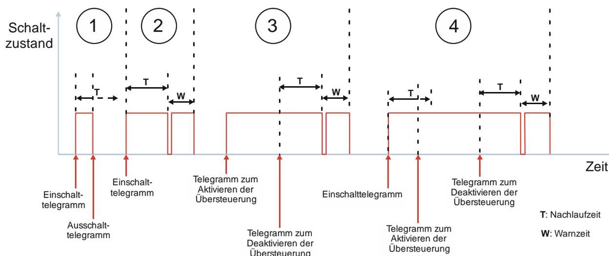
Abb. 39 Verhalten des Schaltaktors im Zeitschalterbetrieb bei parametrierter Übersteuerung (Zwangsführung) und Vorgabe zum Neustart des Zeitschalters bei Deaktivierung der Übersteuerung
