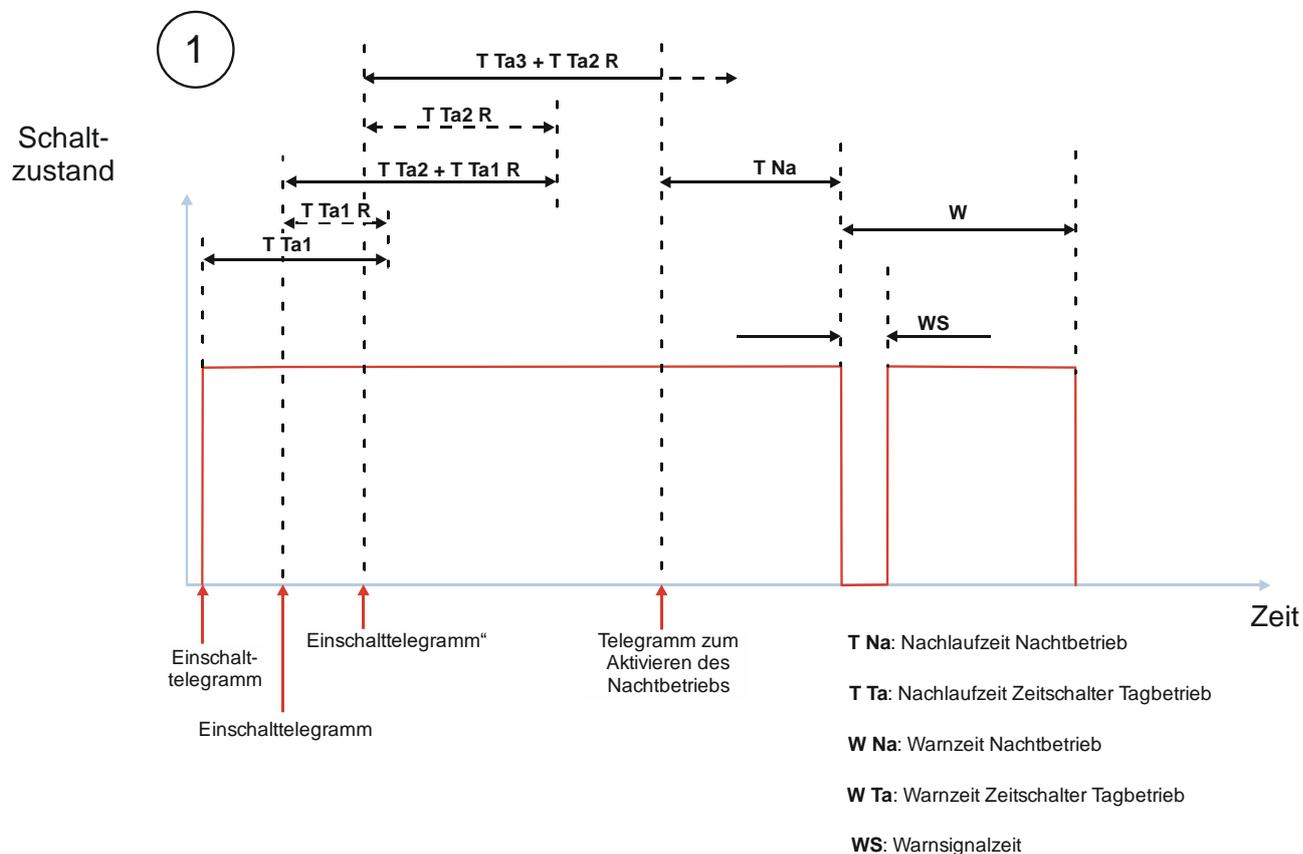
Abb. 36 Verhalten bei Aktivierung und Deaktivierung des Nachtbetriebs im Zeitschalterbetrieb
