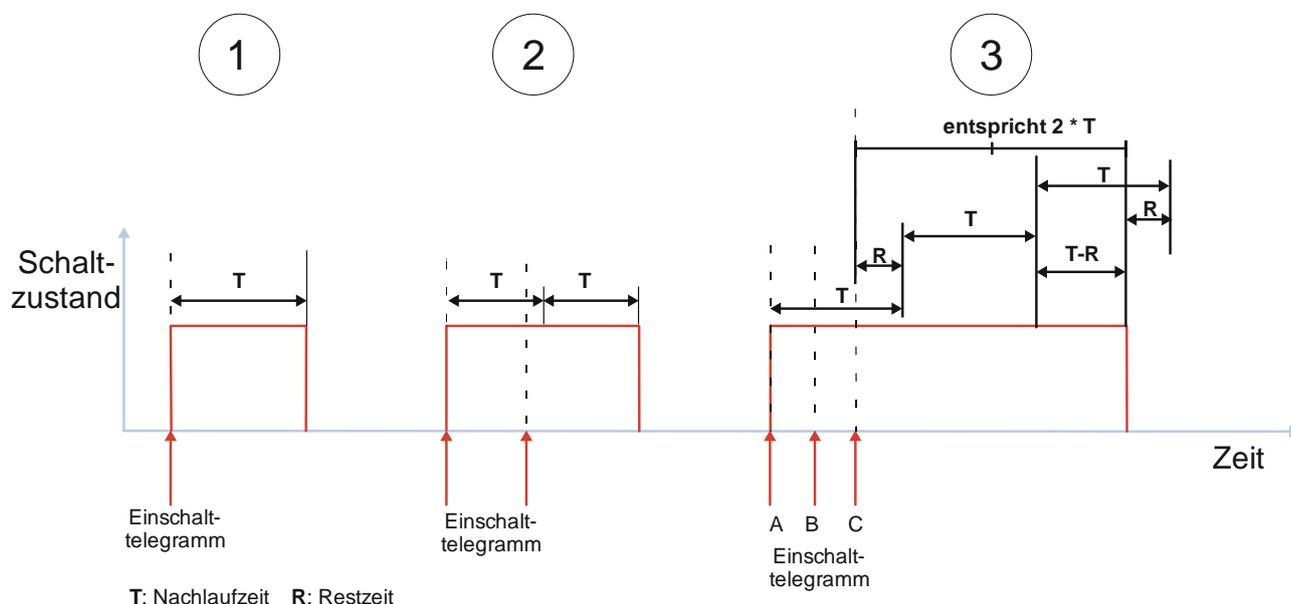
Abb. 31 Verhalten bei Zeitschalterbetrieb mit Einstellung „Nachtriggern möglich“ = „2“
