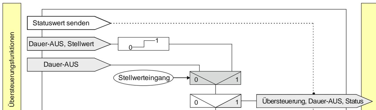
Abb. 13 Übersteuerung „Dauer-AUS“
