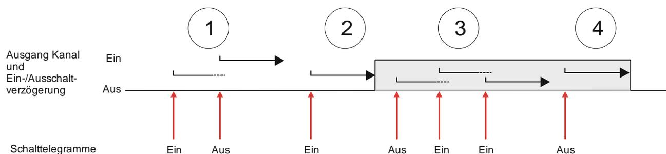
Schaltverhalten bei parametrierter Ein- und Ausschaltverzögerung
