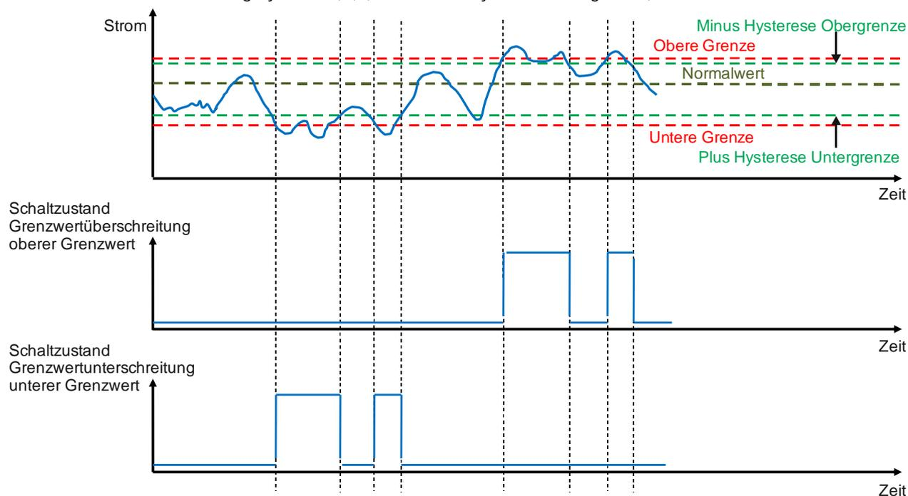
Abb. 20 Diagrammdarstellung Laststromüberwachung
