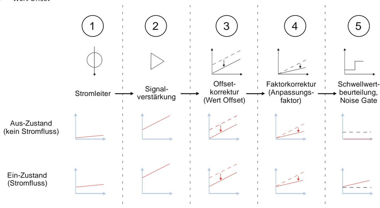
Abb. 19 Wirkung von Offset und Anpassungsfaktor bei der Strommesswerterfassung
