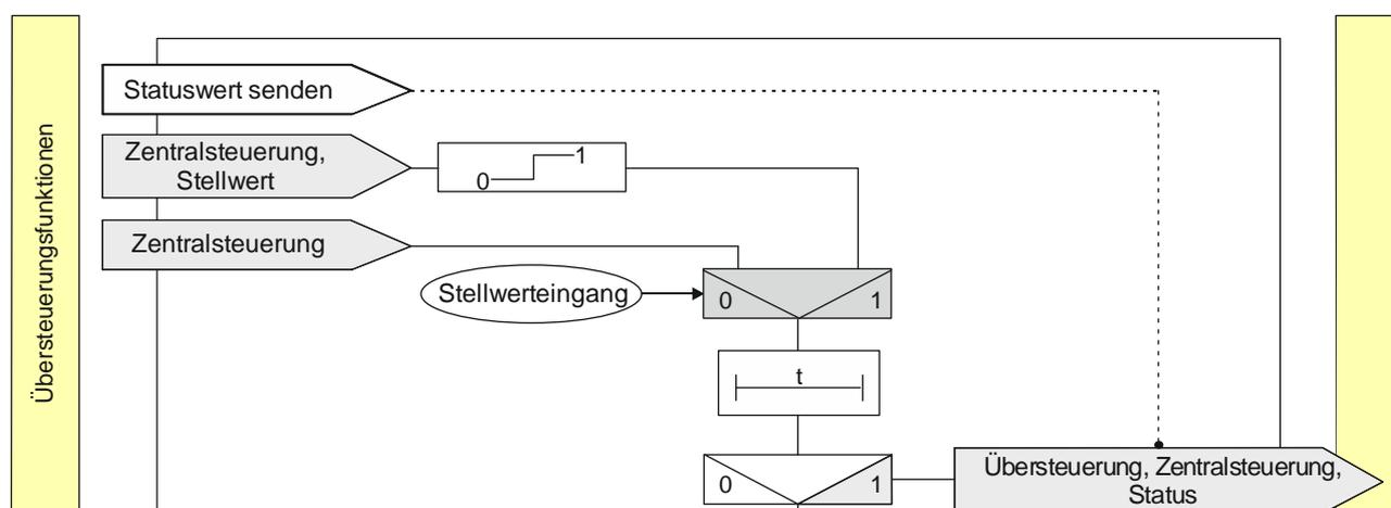
Abb. 15 Zentralübersteuerung
