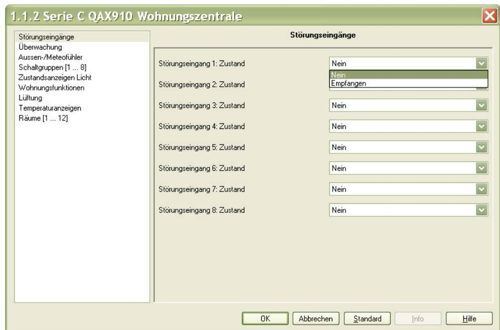
Die Parametrierung wird gestartet, in dem in der Dialogbox mit [Mausklick links] eine Parametergruppe angewählt wird. Dadurch werden die entsprechenden Parameter konfiguriert bzw. sichtbar und die Parameterwerte können eingestellt werden.
