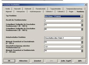
Es ist der Ventilatortyp "lokal" zu wählen. Unter "Anlaufverhalten" muss jedoch "Einschalten über Stufe 2" oder "direkt einschalten" gewählt werden.
