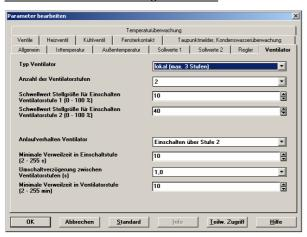
Es ist der Ventilatortyp "lokal" zu wählen. Unter "Anlaufverhalten" muss jedoch "Einschalten über Stufe 2" oder "direkt einschalten" gewählt werden.
