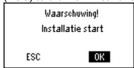
10. Druk op de draaidrukknop voor OK. De toepassing wordt gestart, alle opnemers worden getest, aanwezige opnemers worden voor latere storingsmeldingen gemarkeerd. De hoofdmenu verschijnt:
