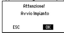
10. Selezionare l'opzione desiderata e premere la manopola per OK. Ora si avvierà l'applicazione, tutti i sensori impiegati saranno verificati, in caso di anomalie apparirà in seguito un messaggio di allarme lampeggiante. Apparirà il menù principale:
