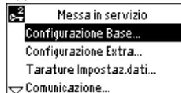
4. Selezionare il sottomenù "Configurazione Base". Selezionare il tipo di impianto/impianto base e la posizione dei moduli opzionali..
