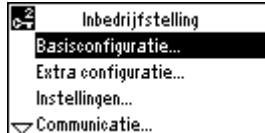
4. Selecteer het submenu "Basisconfiguratie...". Selecteer het installatietype/basistype en de plaats van de uitbreidingsmodule
