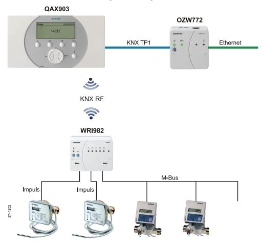
Mit der Einbindung des Verbrauchsdaten-Interface WRI982 kann der Energieverbrauch an der Wohnungszentrale angezeigt und via Web-Server OZW772 einem Dienstleister zugestellt werden.
