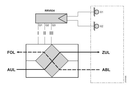
Q1 - Q3 3-Stufenschalter der Lüftungsanlage X1 Luftqualitätsfühler, DC 0...10 V X2 Feuchtefühler, DC 0...10 V
