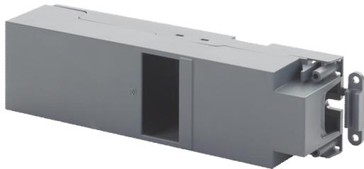
Die Automationsmodulbox AP 118 ist mit 41 mm Höhe für die Installation in der abgehängten Decke, im aufgeständerten Boden, direkt auf eine Wand oder in einem Installationskanal geeignet. Die Befestigung erfolgt über Schrauben an den beiden Enden des Gehäuses.
