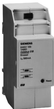
Zur Versorgung der Busteilnehmer wird die notwendige Versorgungsspannung zusammen mit den Datentelegrammen auf einer gemeinsamen Leitung übertragen. Die Drossel N 120 verhindert den Kurzschluß der Datentelegramme auf der Buslinie durch die Versorgungsspannung. Sie greift die Versorgungsspannung von den beiden äußeren Leiterbahnen der Datenschiene ab und speist diese über Induktivitäten auf die beiden inneren Leiterbahnen.
