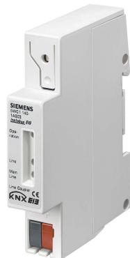
Der Linienkoppler N 140/03 verbindet datenmäßig zwei getrennte EIB-Buslinien miteinander, trennt sie jedoch galvanisch voneinander. Dadurch kann jede Buslinie im lokalen Betrieb unabhängig von den anderen Linien betrieben werden.
