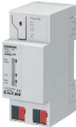
Der Linienkoppler N 140/13 verbindet datenmäßig zwei getrennte *EIB*-Buslinien miteinander, trennt sie jedoch galvanisch voneinander. Dadurch kann jede Buslinie im lokalen Betrieb unabhängig von den anderen Linien betrieben werden.
