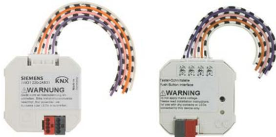
Die Taster-Schnittstellen UP 220/21 und UP 220/31 sind Binärein- und ausgabegeräte zum Einlegen in Geräteverbindungs-dosen (Ø 60 mm, 40 mm tief).
