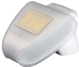
Die Wetterzentrale AP 257/21 enthält in einem kompakten Gehäuse alle Sensoren, die Auswerte-Elektronik und die Bus-Ankopplung. Sie misst Windgeschwindigkeit, Helligkeit und Temperatur, erkennt Dämmerung und Niederschlag und empfängt das DCF77-Funksignal für Datum und Zeit.
