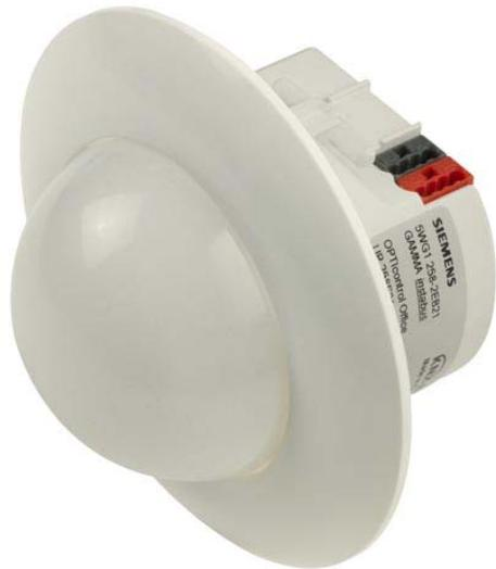
Der UP 258E11 ist ein Präsenz-, Bewegungsmelder mit integrierter 2-Punkt Helligkeitsregelung. Das Gerät UP 258E11 kommuniziert über KNX mit Aktoren oder weiteren KNX - Geräten. Es ist zur Montage an die Decke konzipiert. Der UP 258E11 kann wegen seines schwenkbaren Sensorkopfes auf den geforderten Erfassungsbereich ausgerichtet werden. Die Hauptanwendung des Gerätes ist die automatische Steuerung der Beleuchtung am Büroarbeitsplatz.
