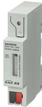
Der Szenen- / Ereignisbaustein N 305 ist ein 1 TE breites Reiheneinbaugerät im N-Maß. Das Applikationsprogramm des Bausteins beinhaltet die Funktionen Szenensteuerung und Ereignisprogramme, wobei bei der Parametrierung eine der beiden Funktionen gewählt werden kann.
