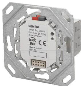
Das UP 510/03 Binärausgabegerät (Relais) mit Hängebügel ist ein KNX Gerät mit zwei Schaltausgängen und einem Bus Transceiver Interface (BTI). Es wird in einer UP-Dose (60 mm Ø, 60 mm tief) installiert. Der Busanschluss erfolgt über eine Busklemme, die Stromversorgung der Aktorelektronik über die Busspannung.
