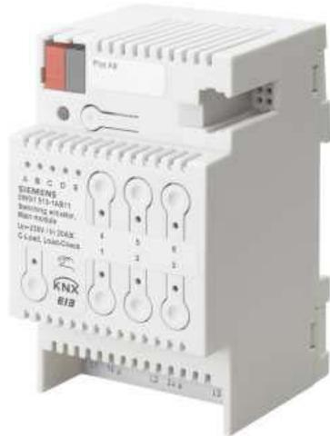
Das Schaltaktor-Hauptmodul N 513/11 ist ein Reiheneinbaugerät im N-Maß. Es kann über seine drei Relaiskontaktausgänge drei voneinander unabhängige Gruppen elektrischer Verbraucher schalten, jeweils mit Laststromerfassung und -überwachung (Last-Check). Der Busanschluss erfolgt über eine Busklemme, die Stromversorgung der Aktorelektronik über die Busspannung.
