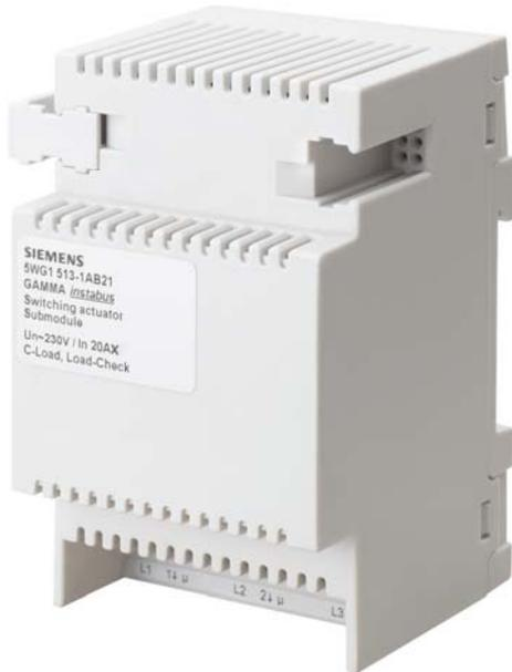
Die Schaltaktor-Erweiterung N 513/21 ist ein Reiheneinbaugerät im N-Maß. Sie kann über ihre drei Relaiskontakt-Ausgänge drei voneinander unabhängige Gruppen elektrischer Verbraucher schalten, jeweils mit Laststromerfassung und -überwachung (Last-Check).
