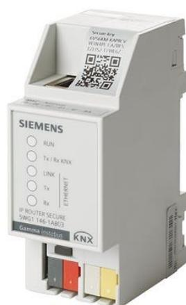
**Der IP-Router verbindet KNX-Linien über Datennetze unter Nutzung des Internetprotokolls (IP) und des KNXnet/IP-Standards. Zugleich ermöglicht dieses Gerät den Buszugriff von einem PC oder anderen Datenverarbeitungsgeräten.**
