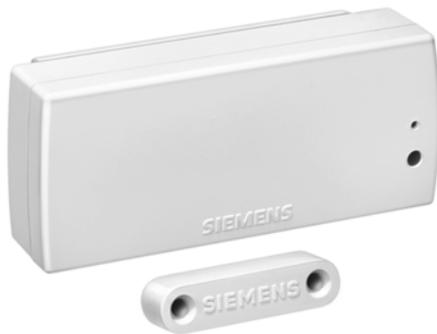
Der Tür-/Fensterkontakt wave AP 260 ist ein Aufputzgerät mit integriertem Funksender. Er erkennt das Öffnen und Schließen von Türen und Fenstern und meldet dies drahtlos. Zusätzlich zu dem in den Funk-Sensor (A3) integrierten Reed-Kontakt, der durch den an der Tür bzw. am Fenster befestigten Magnet (A4) betätigt wird, können ein oder mehrere externe Tür-/ Fensterkontakte in Reihe zum internen Reed-Kontakt angeschlossen werden.
