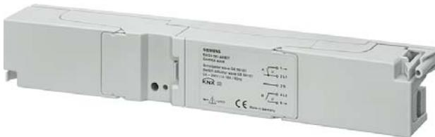
Der Schaltaktor wave GE 561/01 ist ein 2-Kanal Aktor mit integriertem KNX Funkempfänger/-sender und einem Bemessungsstrom von 2x16A zum Schalten elektrischer Verbraucher. Er kann von bis zu 40 Funksensoren angesteuert werden, die mit GAMMA wave Funktechnik ausgestattet sind und in eine Szenensteuerung mit bis zu 16 Szenen eingebunden werden.
