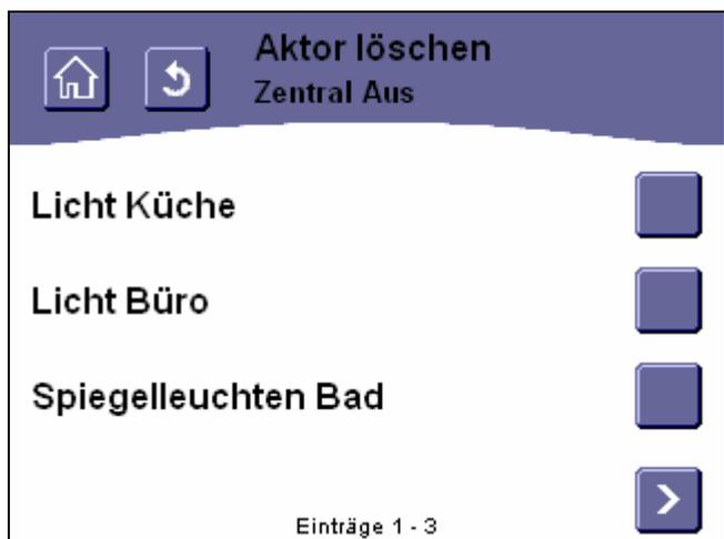
Abbildung 122: Auswählen eines aus einer Szene zu löschenden Aktors
