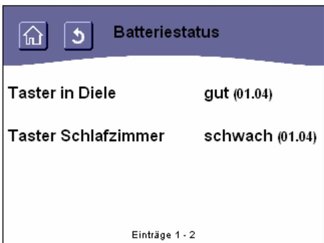
**Abbildung 92: Menü mit Statusinformationen einzelner Geräte mit schwacher Batterie**
