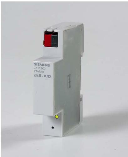
Das 7KT1 900 Kommunikationsmodul KNX/EIB Basic ist ein Reiheneinbaugerät zum Einbau in Verteilungen. Das Gerät sendet Zählerdaten von Elektroenergiezählern 7KT1 5xx auf den Bus.
