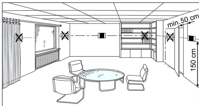
Bild 3: Installationshinweise für Fühler und Temperaturregler
