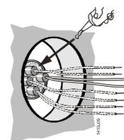
Bild 4: Abdichtung Installationsrohr
