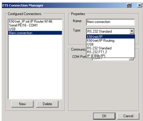
Créez une nouvelle interface et sélectionnez le type KNXnet/IP. ETS3 recherche automatiquement toutes les interfaces IP à portée.
