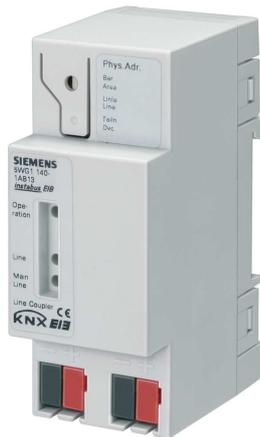
Le coupleur de ligne/zone N 140/13 permet une connexion des données entre 2 lignes de bus KNX, ainsi qu'une isolation des ces 2 lignes, afin de permettre un fonctionnement indépendant des lignes.
