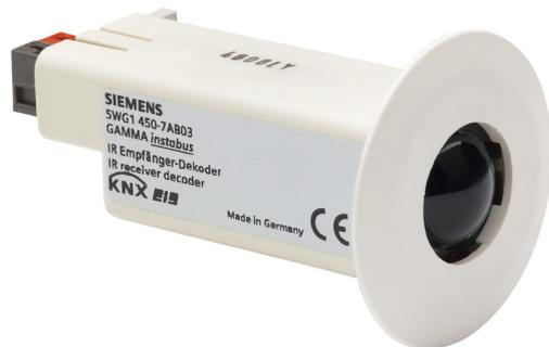
Le récepteur décodeur IR S 450 convertit en télégrammes bus les signaux Infrarouge reçus de la télécommande IR S 425 ou des boutons poussoir IR AP 420, AP 421 et AP 422. Les signaux de commande IR peuvent être évalués en tant que touche individuelle ou en tant que paire de touches.
