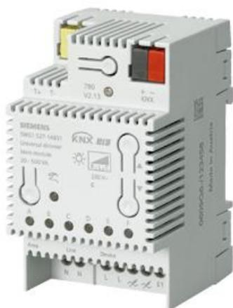
Le variateur universel (module de base) N 527/31 est un appareillage modulaire de type N pour montage sur rail DIN (profilé symétrique), conçu pour le contrôle de l'éclairage, c'est-à-dire pour la commutation et la variation de charges ohmiques, inductives ou capacitives de 20 à 500 VA à 230 V AC, 50-60 Hz. Le raccordement au bus s'effectue via une borne de bus et l'alimentation électrique de l'électronique est assurée par un bloc d'alimentation intégré de 230 V AC.
